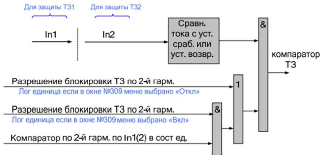
Рисунок 37 – Функциональная схема логики компаратора ТЗ
