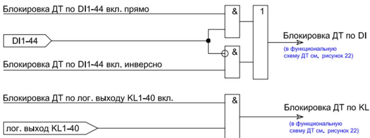
Рисунок 23 – Алгоритм формирования сигналов блокировки (ускорения) ОБР по дискретным входам и логическим выходам реле
