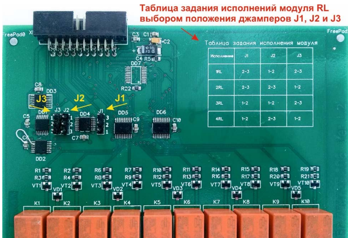
Рисунок 10 – Таблица задания исполнений модуля RL и места установки джамперов J1 , J2 и J3
