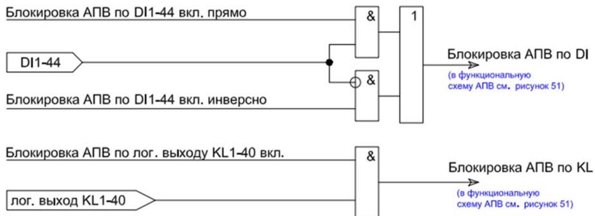
Рисунок 50 – Алгоритм формирования сигналов блокировки АПВ по дискретным входам и логическим выходам реле
